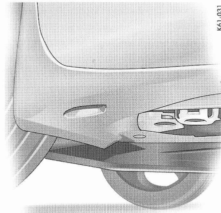
Logement du cric pour changer une roue à l'arrière
