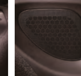
5) Enceintes néodyme 2,5 cm pour les fréquences aiguës et 8,0 cm pour les fréquences moyennes
