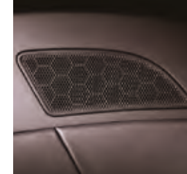
2) Enceinte néodyme 2,5 cm pour les fréquences aiguës
