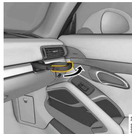
Fig. 192: Déploiement d'un porte-boissons
