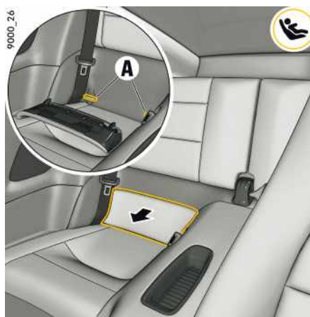
Fig. 270: Fixation ISOFIX sur les sièges arrière
