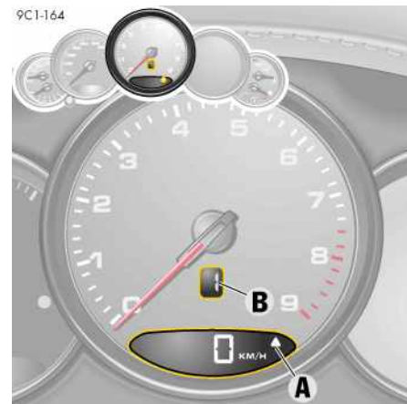
Fig. 27: Voyant de passage au rapport supérieur A et affichage du rapport B
