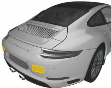
Fig. 11: Capteurs radar dans le pare-chocs arrière
