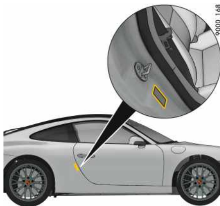
Fig. 299: Emplacement de la plaque signalétique
