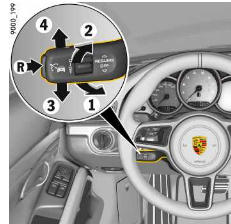
Fig. 203: Levier de commande du régulateur de vitesse adaptatif (ACC)
