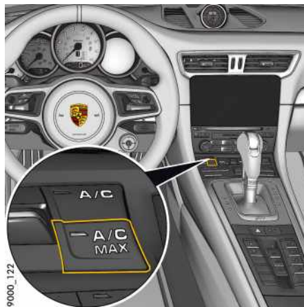
Fig. 81: Activation du refroidissement maximal
