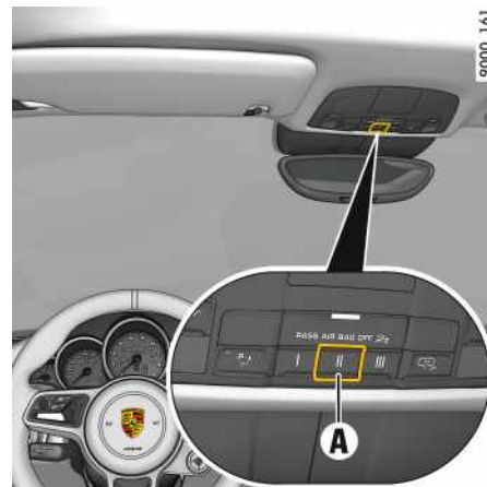
Fig. 93: Programmation du système d'ouverture de porte de garage
