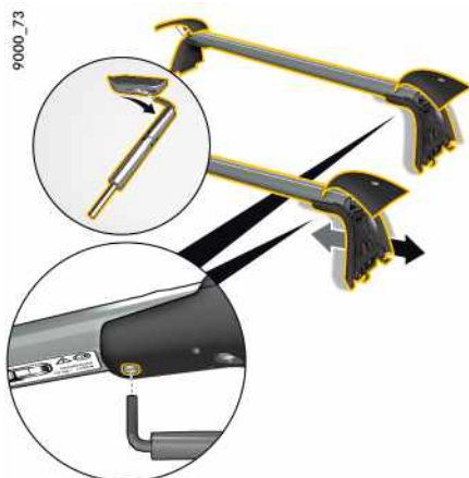
Fig. 256: Desserrage des vis sur le dessous des supports
