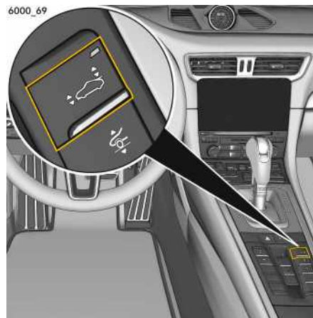
Fig. 4: Touche du spoiler avant et de l'aileron arrière dans la console centrale
