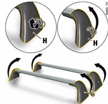
Fig. 255: Déverrouillage et relevage des caches
