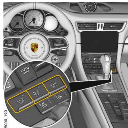
Fig. 77: Touches de répartition de l'air
