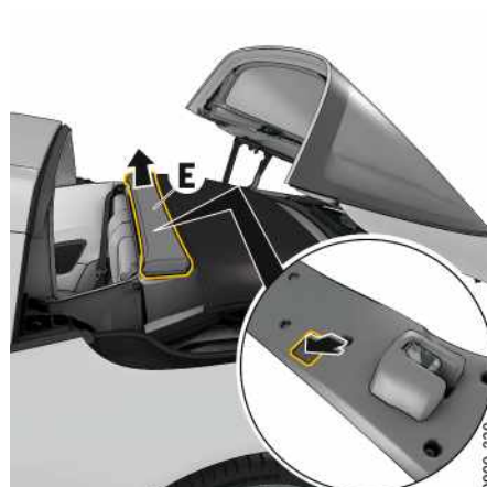
Fig. 243: Dépose du store pare-vue
