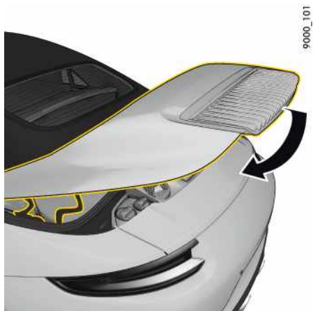
Fig. 60: Fermeture du capot de puits de capote
