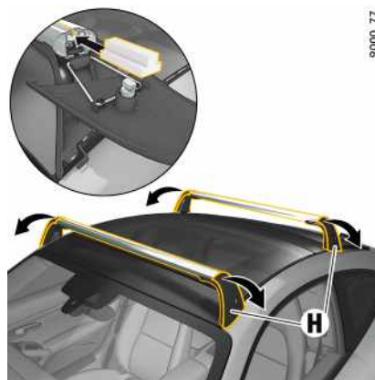
Fig. 260: Insertion du module de transport
