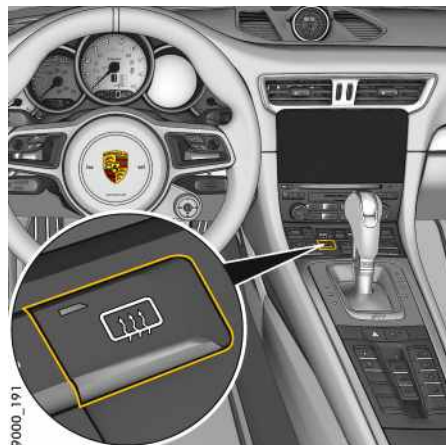
Fig. 101: Touche de dégivrage des rétroviseurs extérieurs
