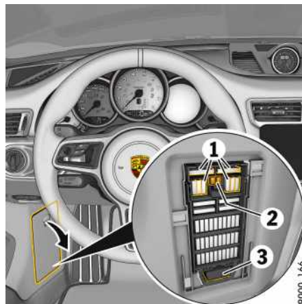
Fig. 134: Éléments dans la boîte à fusibles au niveau du plancher côté gauche
