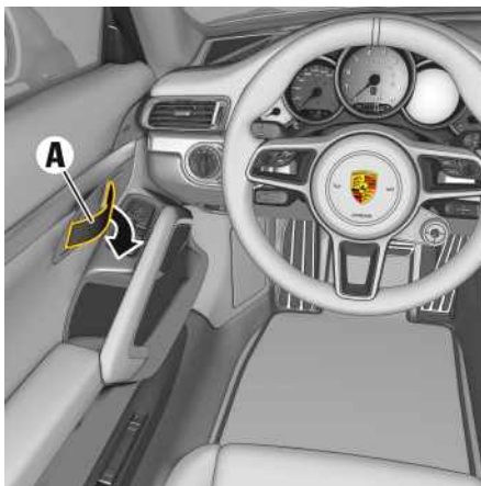
Fig. 289: Ouverture des portes de l'intérieur - 911 Carrera T
