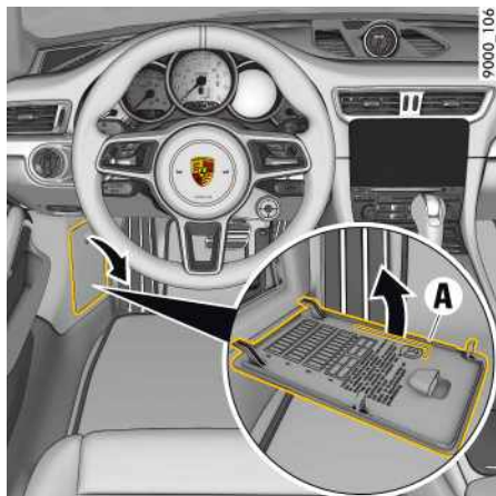
Fig. 71: Extraction du crochet métallique
