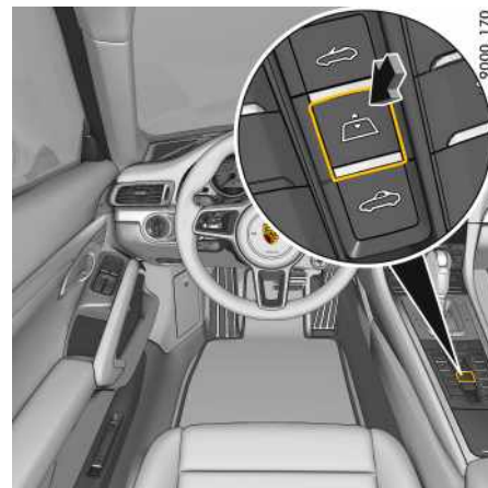
Fig. 41: Redressement et retrait du saute-vent
