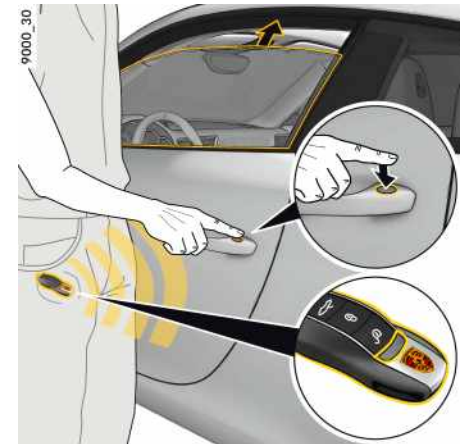
Fig. 294: Fermeture des vitres à l'aide du détecteur de proximité intégré à la poignée de porte (véhicules avec Porsche Entry & Drive)
