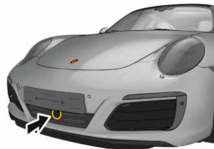
Fig. 202: Position du capteur radar
