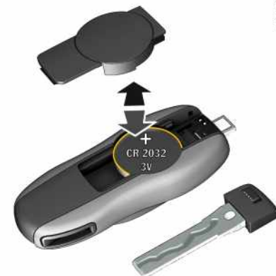
Fig. 70: Remplacement de la pile
