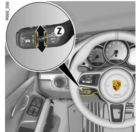
Fig. 205: Réglage de la distance de régulation
