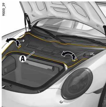
Fig. 86: Dégagement et soulèvement du cache en plastique
