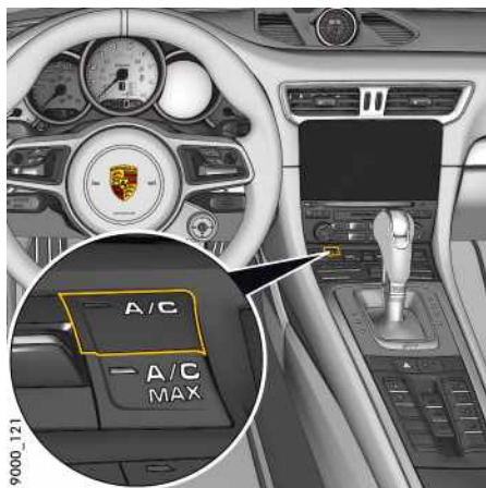
Fig. 80: Activation et désactivation de la fonction de refroidissement
