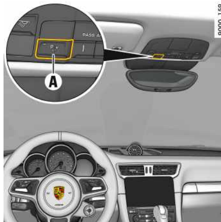
Fig. 19: Touche sur l'unité de commande du toit
