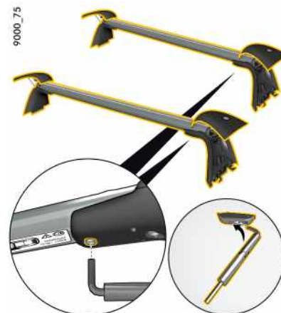
Fig. 258: Serrage des vis sur le dessous des supports
