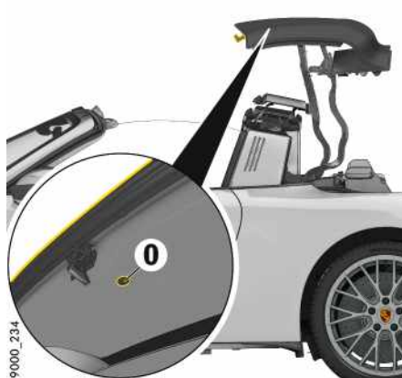
Fig. 246: Retrait du bouchon au niveau de l'accès pour l'actionnement de secours du verrouillage de toit
