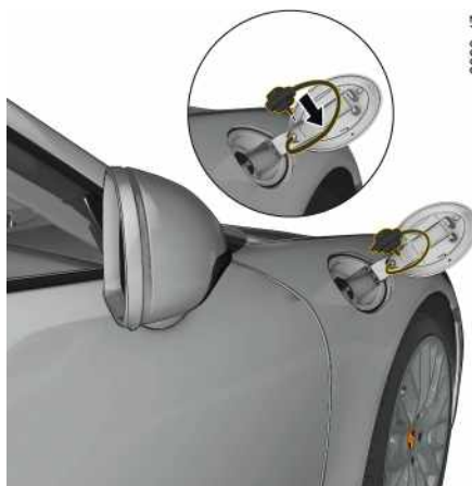
Fig. 198: Ouverture du bouchon du réservoir
