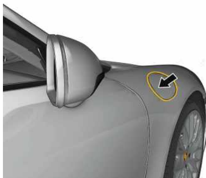
Fig. 197: Ouverture de la trappe du réservoir
