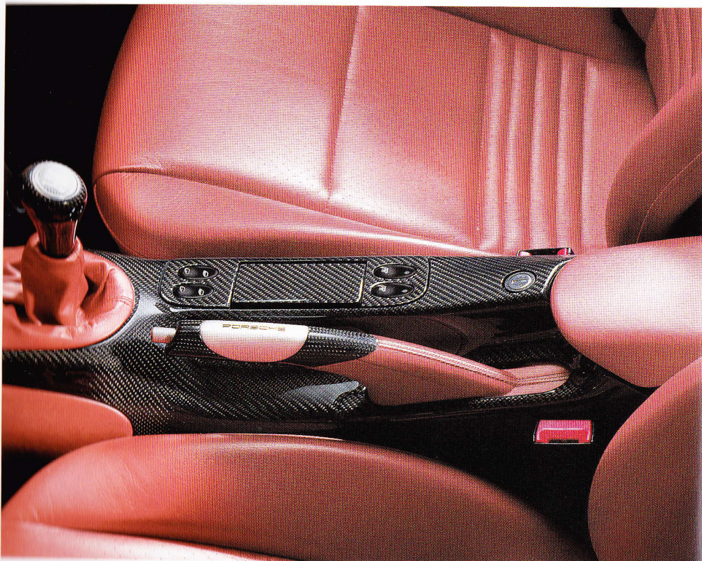
Levier de vitesse et levier de frein à main en carbone et cuir (Boxster), console centrale arrière en carbone
