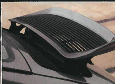
Attention au bon fonctionnement de l'aileton qui est indispensable au refroidissement moteur
